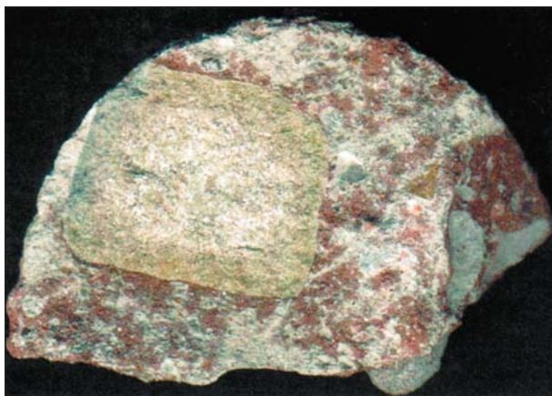
Обломок интрузивной породы в туффизите с проникающей в него реакционной каемкой. Скважина 6, интервал 77.5–84.0 м. Диаметр керна 7.2 см.
