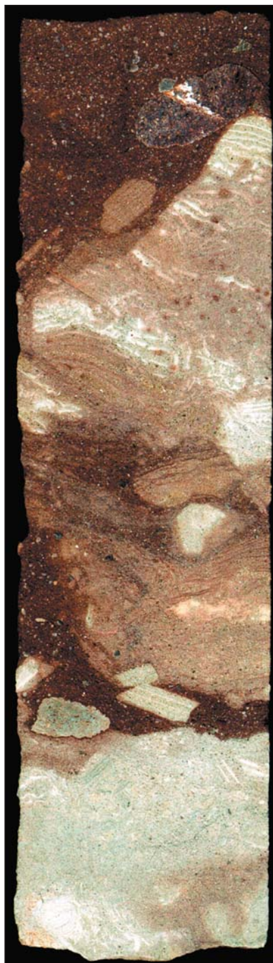
Дезинтеграция доломита в туффизите. Вверху обломки слоистого доломита сохранилась первичная текстура, внизу видны отделившиеся от него фрагменты. Скважина 7, глубина 114 м. Диаметр керна 7.2 см. Здесь и далее фото авторов
